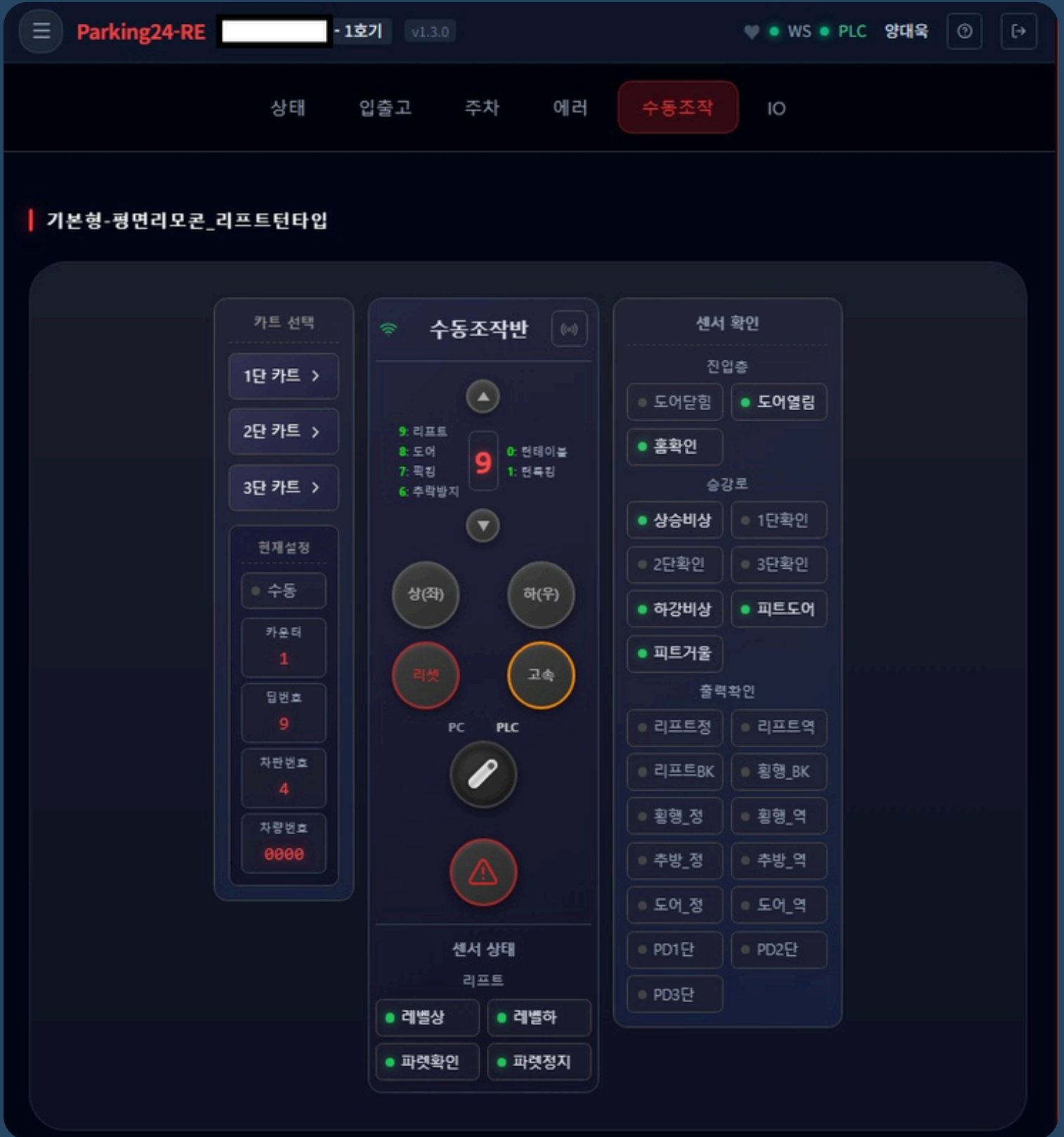
수동 조작반 — 도어/리프트/카드 원격 제어, 센서 상태 실시간 표시
